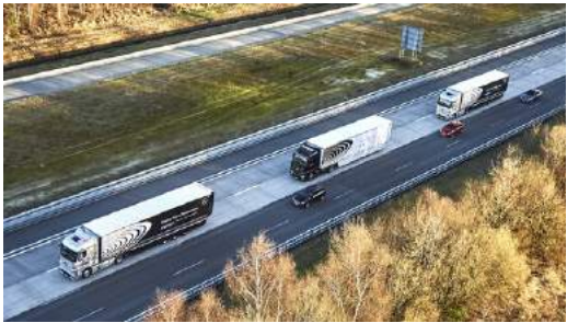
(iii) Αυτόνομα φορτηγά της Daimler κινούνται ως platoon σε αυτοκινητόδρομο
