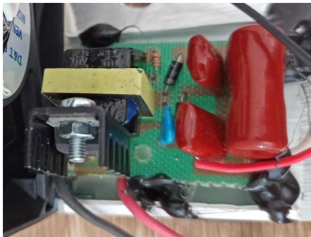
Εικόνα 77: Φωτογραφία πλακέτας υψηλής τάσης που χρησιμοποιήθηκε στην πειραματική διάταξη.
