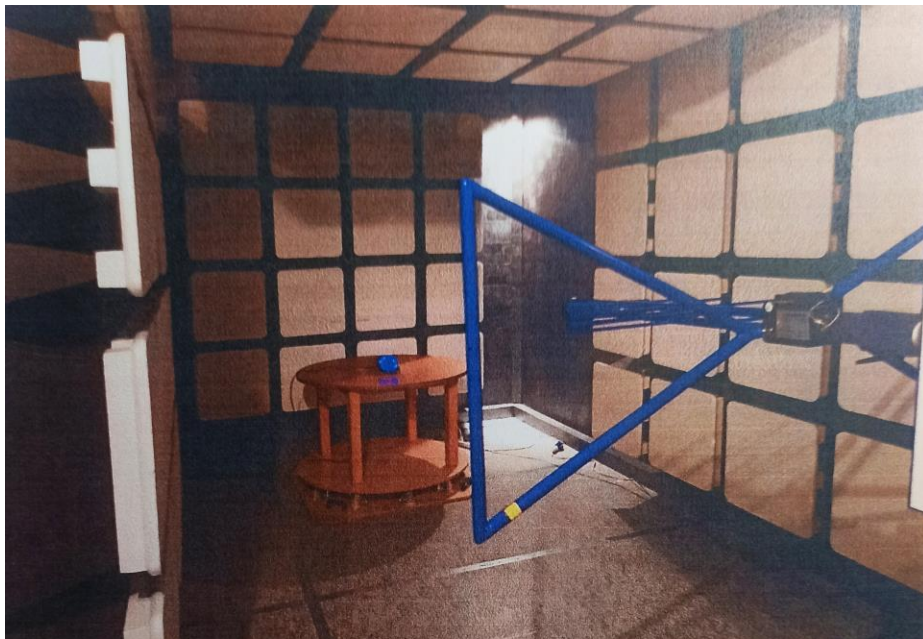
Εικόνα 43: Εγκατάσταση για έλεγχο ακτινοβολούμενων εκπομπών (30MHz-1GHz)
