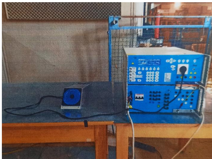
Εικόνα 68: Εγκατάσταση για δοκιμή πτώσεων τάσης και βραχυπρόθεσμων διακοπών
