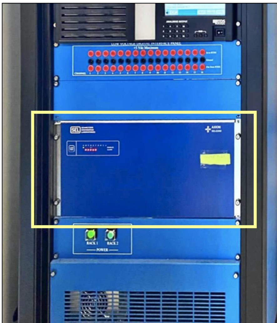
Εικόνα 4.5: Προγραμματιζόμενος λογικός ελεγκτής πραγματικού χρόνου SEL-2240 Axion.
