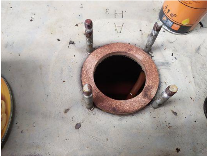
Εικόνα 42 Παρεμβύσματα στη βάση του μονωτήρα
