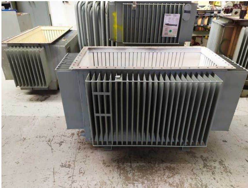
Εικόνα 35 Ανοικτό Κέλυφος Μ/Σ – Ψήκτρα
