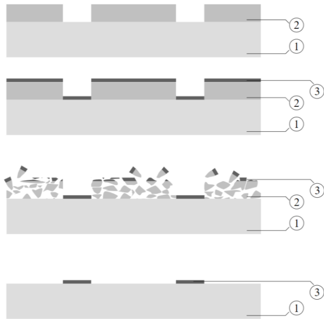
Εικόνα 34 : Σχηματική αναπαράσταση των σταδίων της οπτικής λιθογραφίας και του Lift off. 1. Υπόστρωμα 2. Φωτοευαίσθητη ρητίνη 3. Στρώμα μετάλλου [55].
