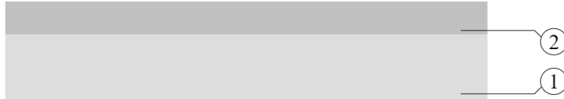
Εικόνα 33: Τα αρχικά στρώματα της διάταξης. 1. Υπόστρωμα 2. Φωτοευαίσθητη ρητίνη [55]
