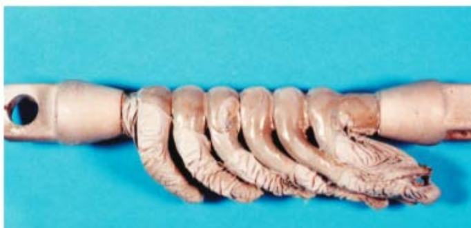
Σχήμα 1-11 : Υδρόλυση εποξικού περιβλήματος [20]
