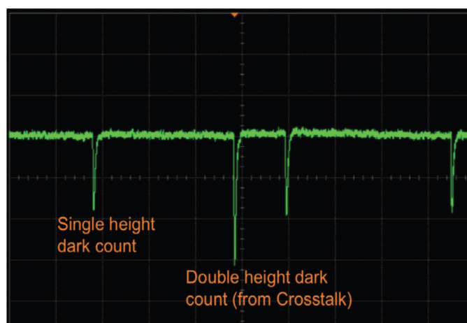
Σχήμα 3.14 Στιγμιότυπο παλμογράφου όπου φαίνονται τα dark counts . (ON Semiconductor Is Now, n.d.) [21]
