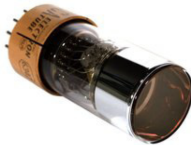
Σχήμα 3.4 Ένας τυπικός Φωτοπολλαπλασιαστής σε σωλήνα [21]
