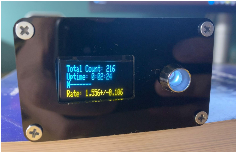
Σχήμα 5.6 Δεδομένα εξόδου που προβάλλει η οθόνη OLED
