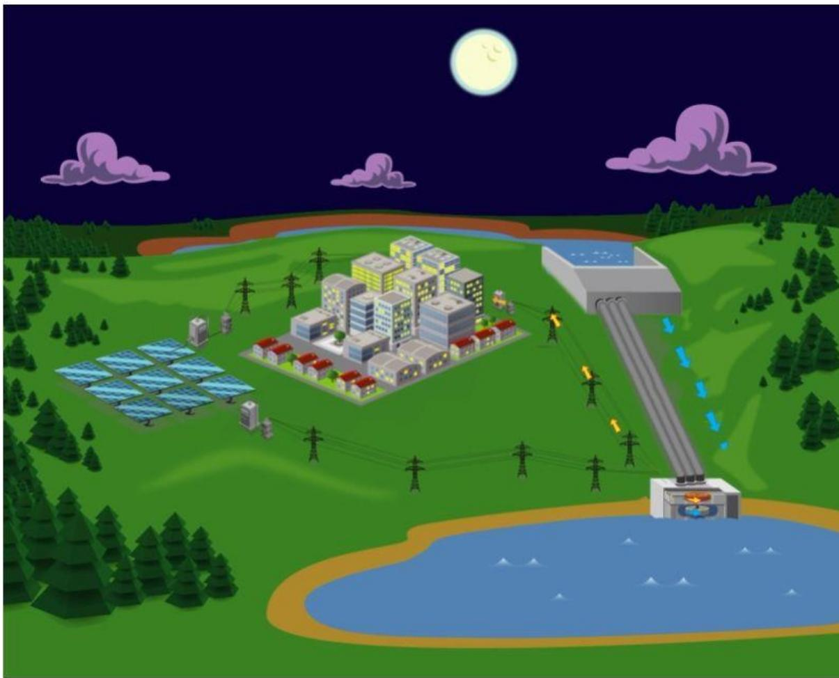
**Σχήμα 2.6:** Λειτουργία υδροηλεκτρικού σταθμού αντλησιοταμίευσης ως σύστημα αποθήκευσης ενέργειας (εκφόρτιση) [27]
