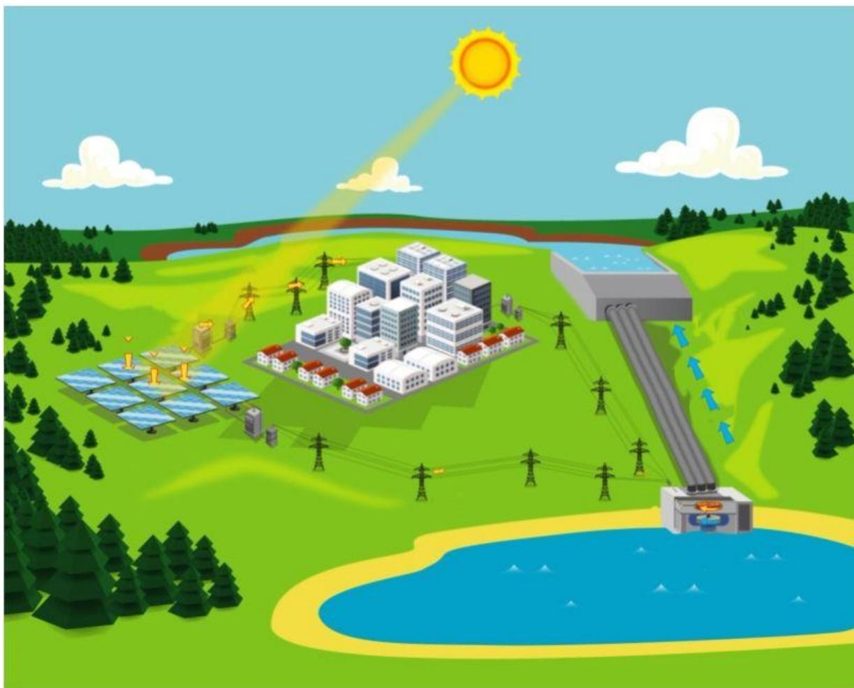
**Σχήμα 2.5:** Λειτουργία υδροηλεκτρικού σταθμού αντλησιοταμίευσης ως σύστημα αποθήκευσης ενέργειας (φόρτιση) [27]
