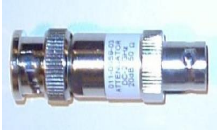
Εικόνα 3.4. Ο εξασθενητής (attenuator)
