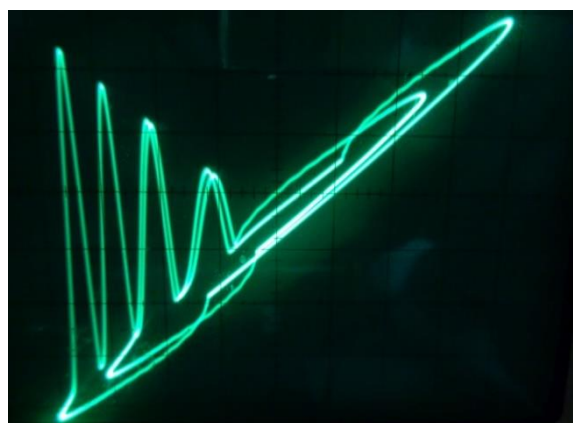
Σχήμα 8.13 Απόκριση οδηγού LED, περίοδος-2, 126 kHz, γράφημα χώρου φάσεων (δίοδος 1N4148).
