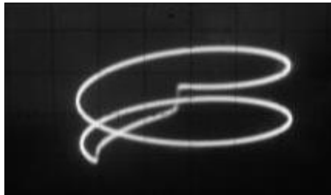
Σχήμα 6.26 Τάση εισόδου V_{rms}=1.88 V-συχνότητα εισόδου 100 kHz-διπλασιασμός περιόδου.
