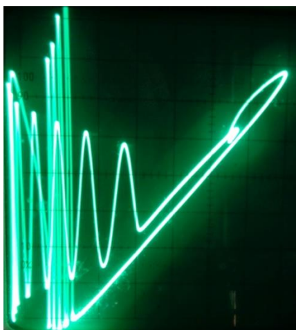
Σχήμα 8.7 Απόκριση οδηγού LED, περίοδος-1, 56 kHz, γράφημα χώρου φάσεων (δίοδος BYG20J).
