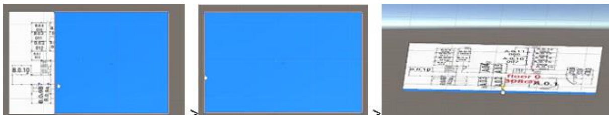
Εικόνα 6.9 Προσαρμογή scale του plane του εδάφους ώστε να ταιριάζει με αυτό των floor plans
