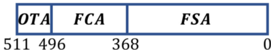
Σχήμα 2.17: Παράδειγμα ενός Block μεγέθους 512 bits. Το Block έχει FSA με 46 θέσεις για αποτυπώματα 8-bit, FCA με μετρητές 2-bit για 64 buckets (κάθε bucket έχει 3 θέσεις για αποτυπώματα), και OTA μεγέθους 16-bit.
