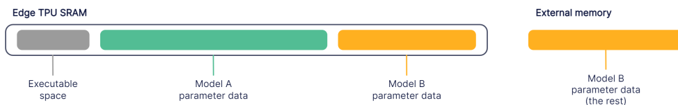
Figure 2.7: Edge TPU RAM parameter data fitting
