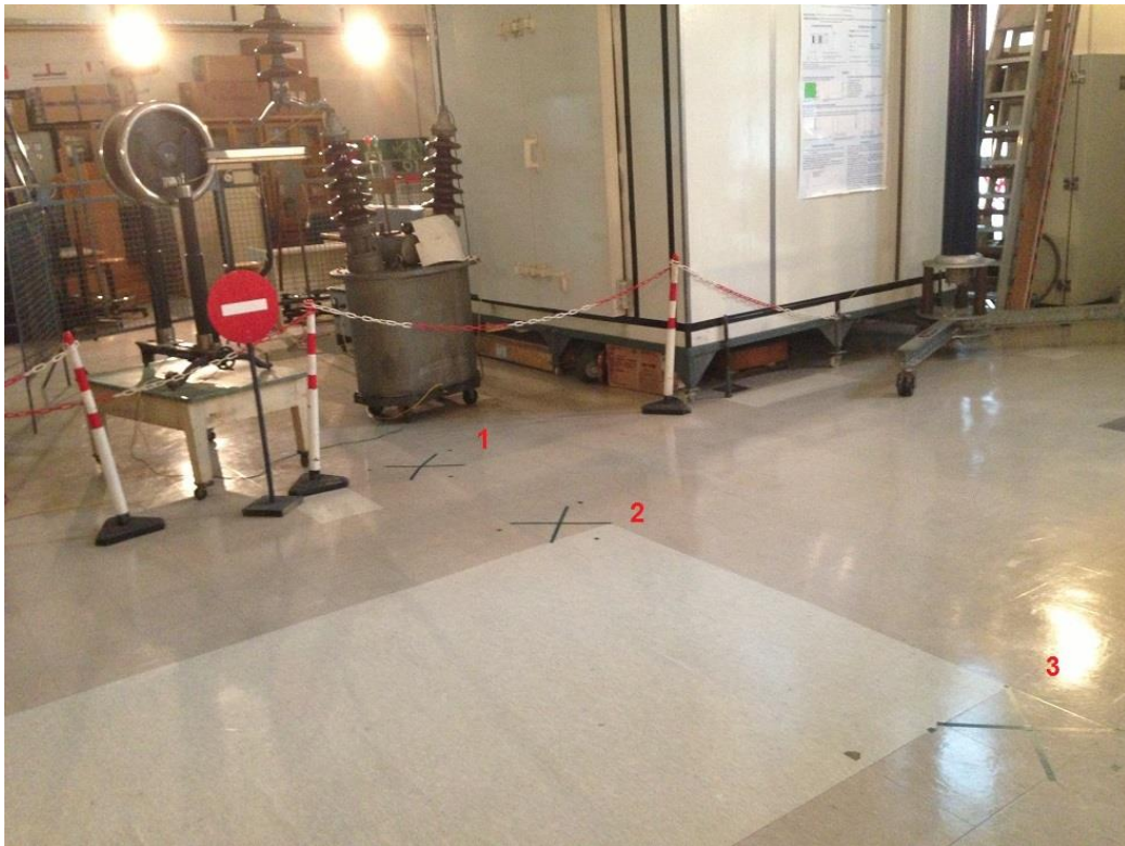
Εικόνα 5.6: Θέσεις μέτρησης 1, 2 και 3 του ηλεκτρικού πεδίου. Στο βάθος φαίνεται το ομοίωμα της γραμμή μεταφοράς συνδεδεμένο με τον μετασχηματιστή.
