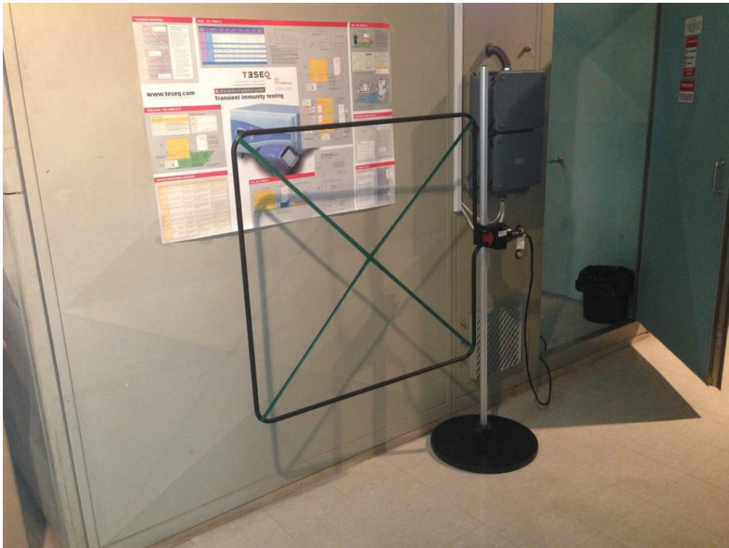
Εικόνα 5.9: Πηγίο στο κέντρο του οποίου μετρήθηκε το μαγνητικό πεδίο και η συχνότητά του.
