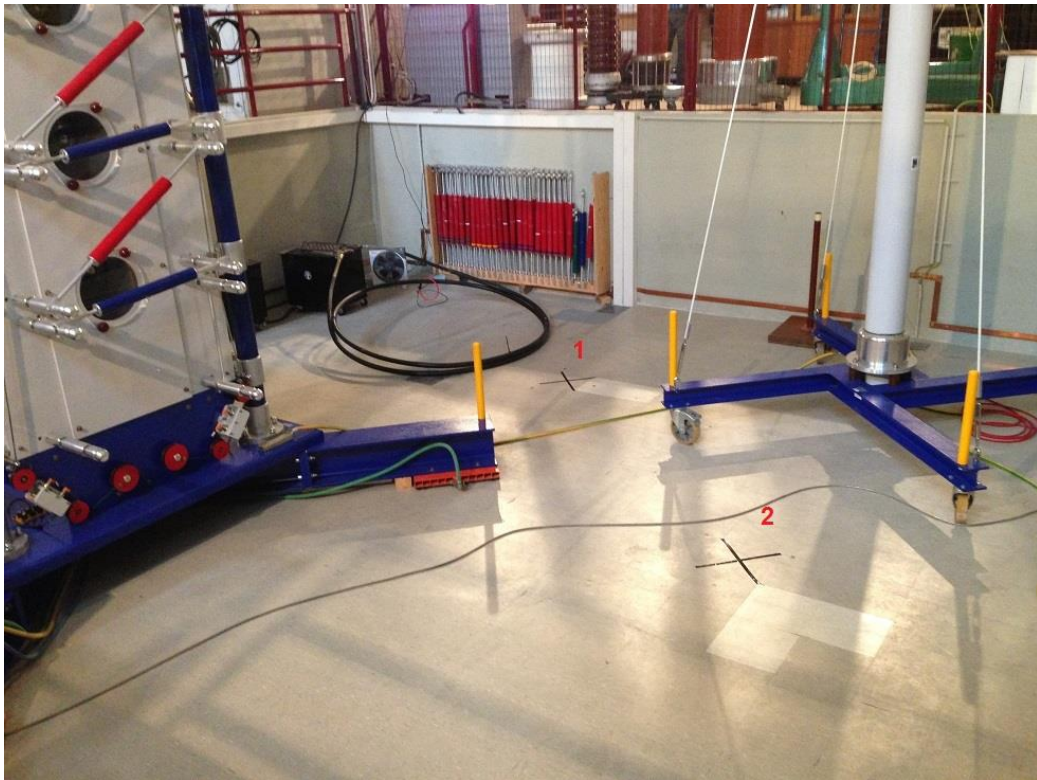
Εικόνα 5.7: Θέσεις μέτρησης 1 και 2 του μαγνητικού πεδίου. Πίσω αριστερά φαίνεται ο ρευματοφόρος αγωγός.
