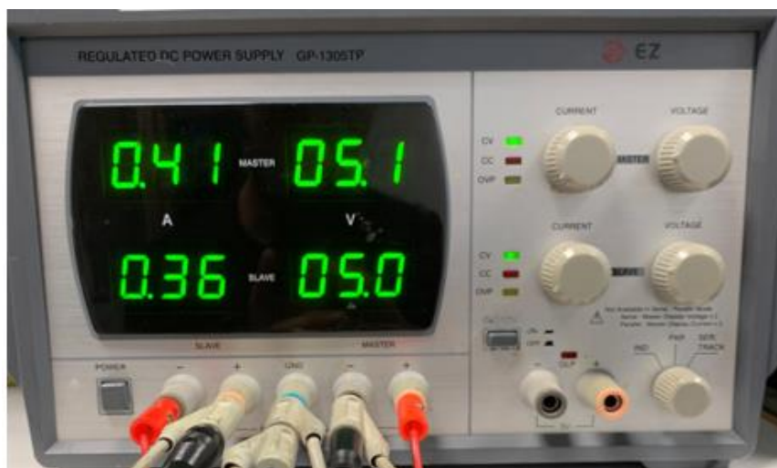
Σχήμα 4.2.4.2 DC τροφοδοσία κυκλώματος breadboard μέσω τροφοδοτικού.
