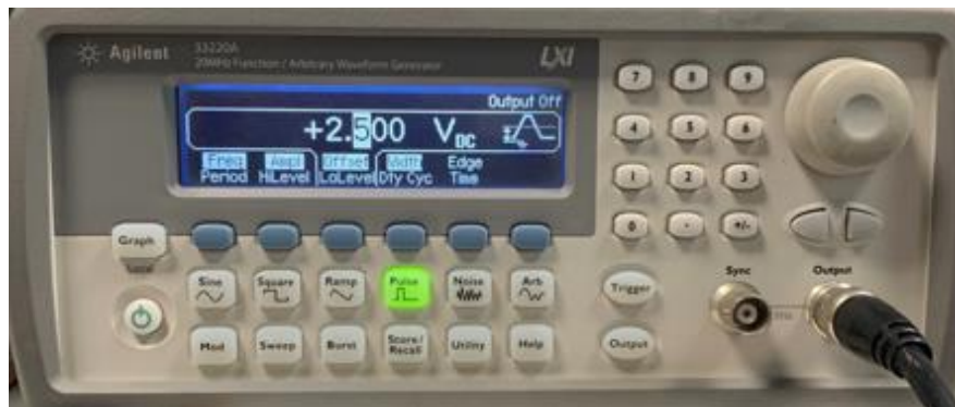
Σχήμα 4.2.4.5 Προσθήκη DC offset στον παλμό εισόδου V_{DC}=2,5V ώστε να μην υπάρχει αρνητικό πλάτος.
