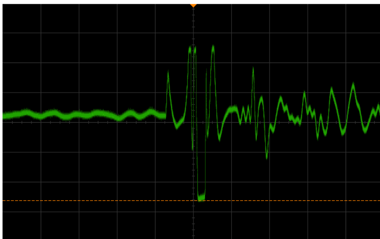
Σχήμα 5.2.1.3 Μεταβολή σήματος εξόδου INA128 με εισαγωγή εξωτερικού μαγνητικού πεδίου (μαγνήτης) στη διάταξη MDL.
