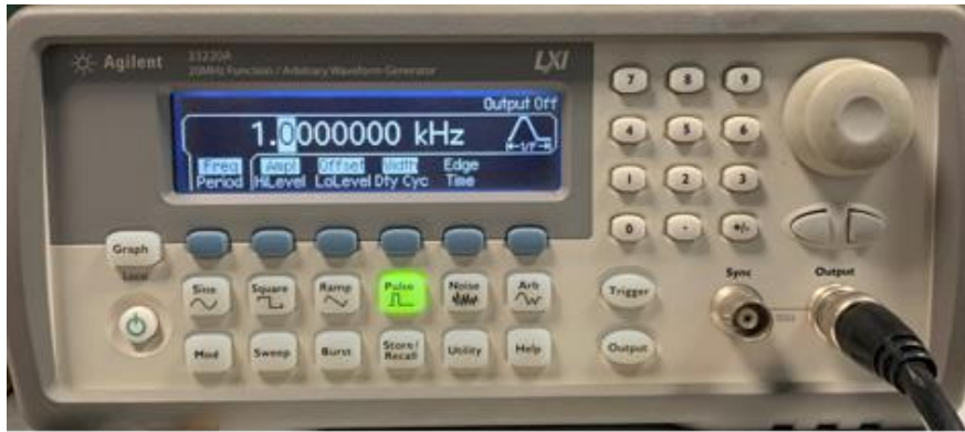
Σχήμα 4.2.4.3 Λειτουργία παλμικού σήματος εισόδου σε συχνότητα 1kHz.
