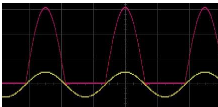
Σχήμα 4.3.1.1 Μετατροπή σήματος εισόδου (κίτρινο) μετά από την επεξεργασία του από το κύκλωμα λήψης. Το σήμα εξόδου (κόκκινο) είναι πλέον ενισχυμένο και ανορθωμένο. [38]
