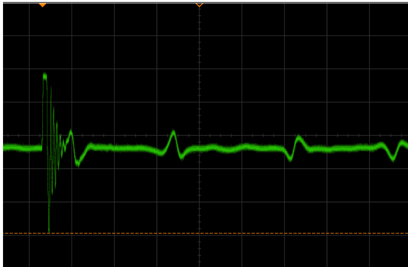
Σχήμα 5.2.2.3 Μεταβολή σήματος εξόδου superdiode με εισαγωγή εξωτερικού μαγνητικού πεδίου (μαγνήτης) στη διάταξη MDL.
