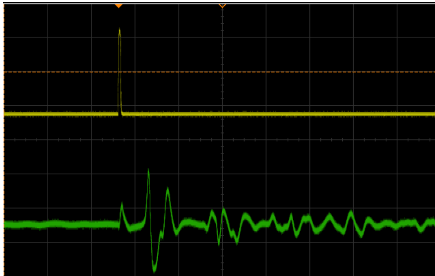
Σχήμα 5.2.1.4 Απεικόνιση καθυστέρησης του σήματος εξόδου του ενισχυτικού σταδίου σε σχέση με τον παλμό στο άκρο της πύλης του mosfet.
