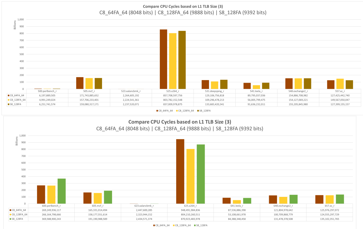
Σχήμα 5.5: Πλήθος κύκλων επεξεργαστή για την περάτωση των benchmarks - S8_128FA - C8_64FA_64 - C8_128FA_64
