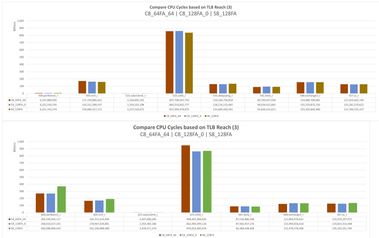
Σχήμα 5.11: Πλήθος κύκλων επεξεργαστή για την περάτωση των benchmarks - S8_128FA C8_64FA_64 C8_128FA_0
