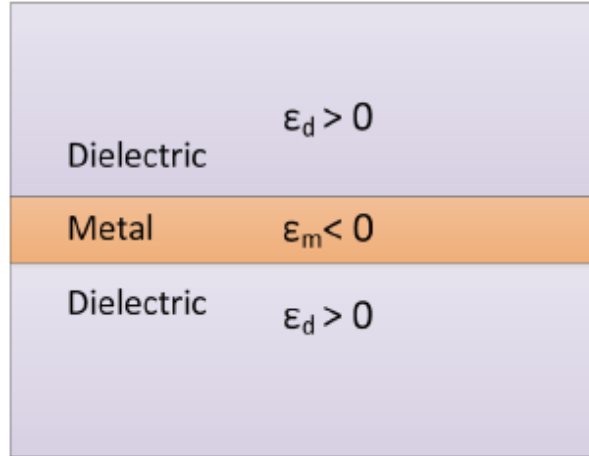
Σχήμα 9 – Συμμετρική διαμόρφωση διηλεκτρικού / μετάλλου / διηλεκτρικού σε πλάσμαονικό κυματοδηγό. \epsilon_d : διηλεκτρική σταθερά του διηλεκτρικού, \epsilon_m : διηλεκτρική σταθερά του μετάλλου [14]
