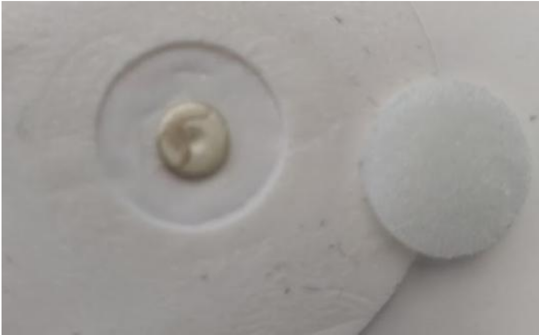
Σχήμα 10: Εμπρόσθια όψη ηλεκτροδίου όπου φαίνεται η ωμική του επαφή και δίπλα ακριβώς το σφουγγαράκι που αφαιρέθηκε.
