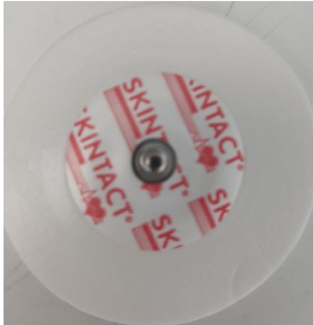
Σχήμα 8: Οπίσθια όψη ηλεκτροδίου όπου φαίνεται η επαφή για τη σύνδεση με το κύκλωμα.
