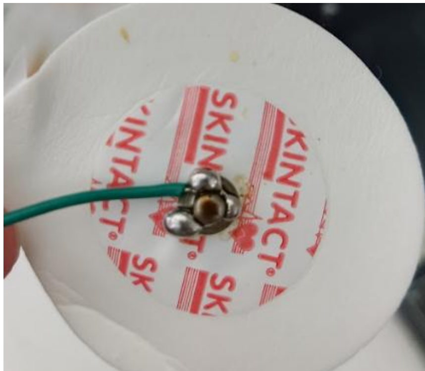
Σχήμα 11: Οπίσθια όψη ηλεκτροδίου μαζί με μονόκλωνο κολλημένο καλώδιο.
