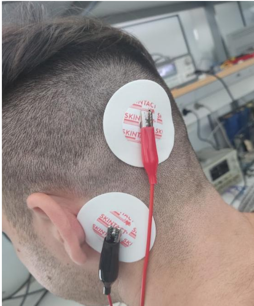
Σχήμα 12: Ηλεκτρόδια μαζί με καλώδια σήματος O1 (κόκκινο) και αναφοράς πίσω από το αριστερό αυτί (μαύρο).
