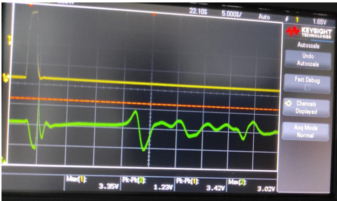
Σχήμα 5.2.10 Έξοδος συστήματος για P=105 MPa
