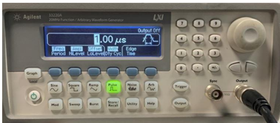
Σχήμα 4.2.4.3 Duty cycle παλμού
