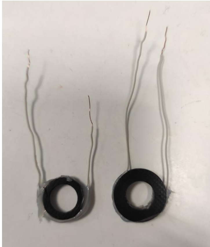
Σχήμα 4.1.1 Πηνίο διέγερσης (Αριστερά), Πηνίο λήψης (δεξιά)
