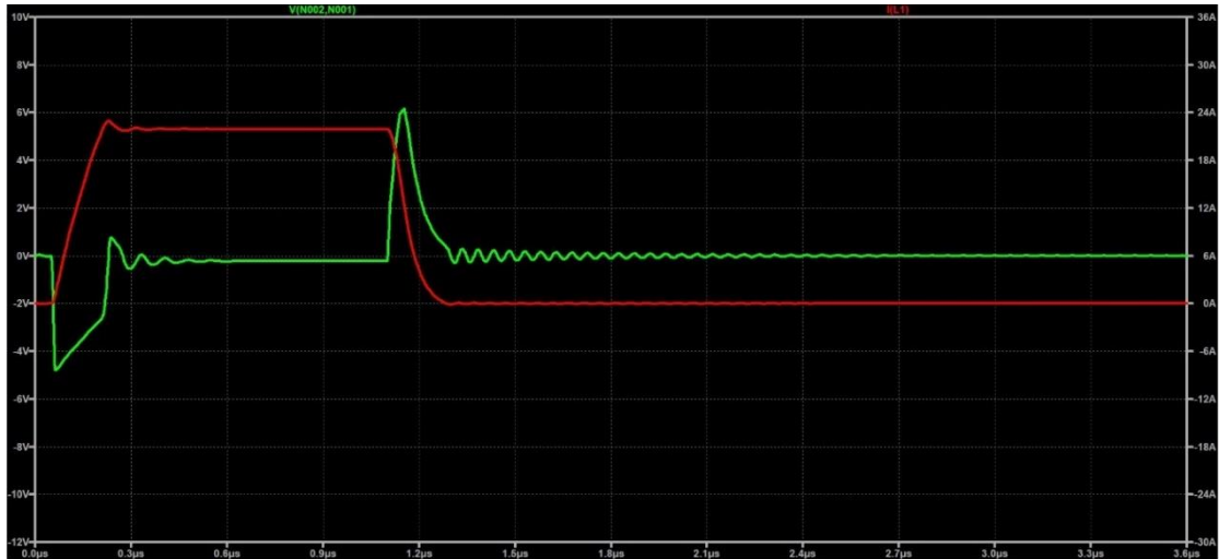
Σχήμα 4.2.3.7 Τάση στα άκρα του πηνίου διέγερσης(πράσινο χρώμα) και ρεύμα πηνίου διέγερσης(κόκκινο χρώμα)
