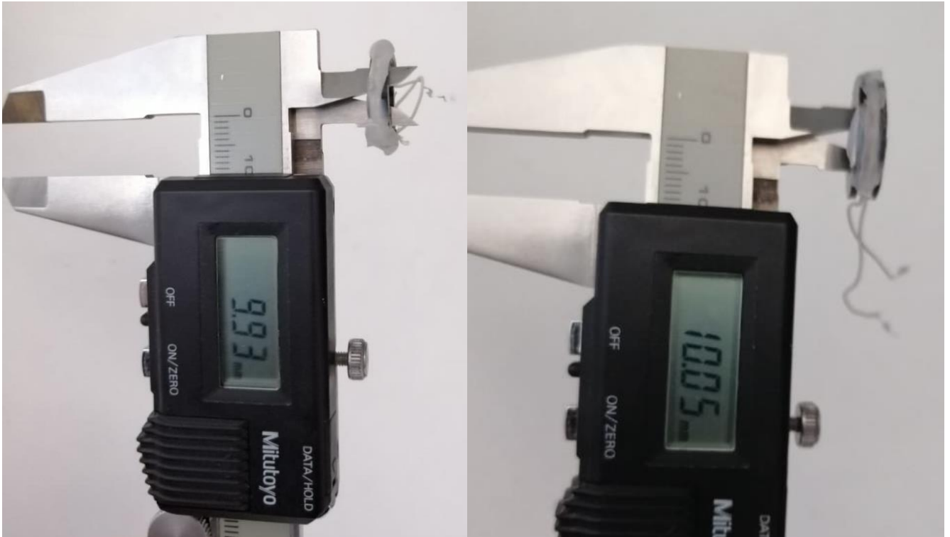
Σχήμα 4.1.3 Διάμετρος περιελίξεων πηνίου διέγερσης (δεξιά), διάμετρος περιελίξεων πηνίου λήψης(αριστερά)
