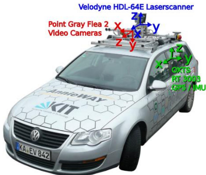
Εικόνα 4.1. Το σύστημα που χρησιμοποιήθηκε για την συλλογή των δεδομένων από το Kitti Benchmark Suite . Στην εικόνα φαίνονται οι 2 κάμερες ο laser scanner και το σύστημα gps [75], http://www.cvlibs.net/datasets/kitti/ .
