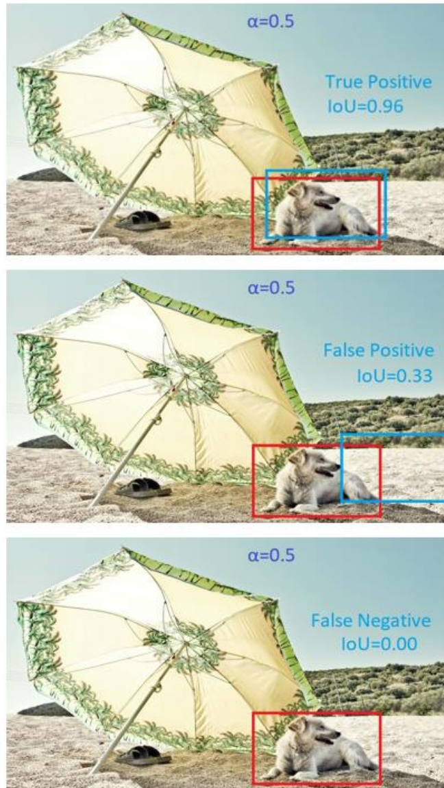
Εικόνα 2.1. Το IoU threshold είναι 0.5. Στην πάνω εικόνα το IoU είναι μεγαλύτερο από το IoU threshold οπότε η πρόβλεψη λαμβάνεται ως True Positive . Στην μεσαία εικόνα είναι μικρότερο του threshold οπότε λαμβάνεται ως False Positive . Στην κάτω εικόνα το μοντέλο δεν προβλέπει κτίο για το στιγμιότυπο, συνεπώς «χάνει» το στιγμιότυπο και το IoU = 0 , False Negative . Φωτογραφία από τον Marko Milivojevic.
