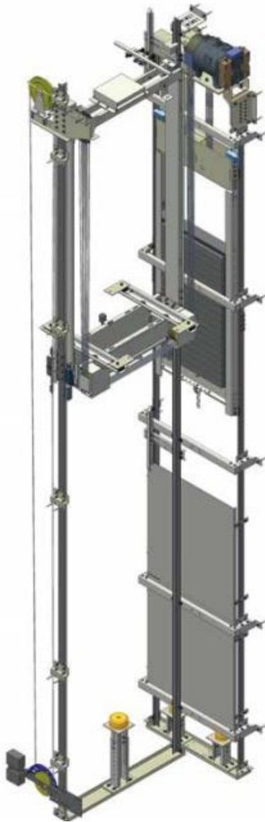
Εικόνα 13: Ανάρτηση μηχανής στην άνω απόληξη και τροχαλία τριβής απέναντι από τη μηχανή (Kleemannlifts, 2020)
