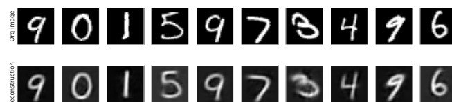
Σχήμα 5.7: Αντιπαραβολή της εικόνας εισόδου (πρώτη γραμμή) με την ανακατασκευασμένη εικόνα (δεύτερη γραμμή). Βλέπουμε ότι το δίκτυο μπορεί να λειτουργήσει ικανοποιητικά και ως αυτοκωδικοποιητής (autoencoder). Η θολούρα των εικόνων ανακατασκευής βελτιώνεται με την αύξηση των εποχών.
