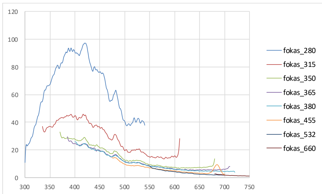
Γράφημα 23: Φάσμα φθορισμού του δείγματος χαρτιού FOKAS. Με διαφορετικό χρώμα εμφανίζονται τα διαφορετικά μήκη κύματος διέγερσης.
