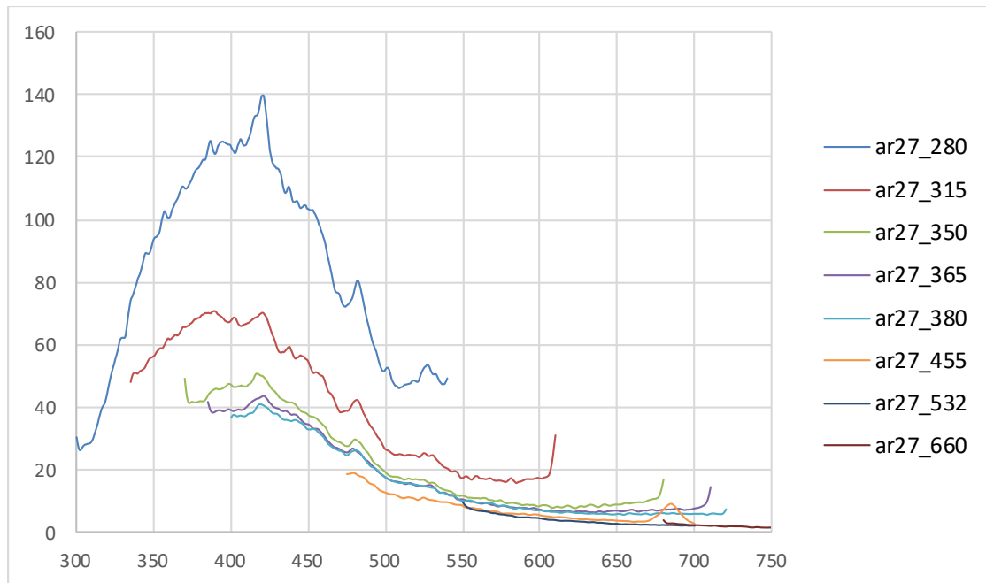
Γράφημα 16: Φάσμα φθορισμού του δείγματος χαρτιού AR27, έπειτα από 27 ημέρες επεξεργασίας ( 105^{\circ}C ). Με διαφορετικό χρώμα εμφανίζονται τα διαφορετικά μήκη κύματος διέγερσης.
