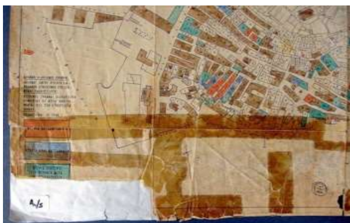
Εικόνα 2.9: Παράδειγμα απόπειρας επιδιόρθωσης με κολλητικές ταινίες σε χαρτί που έχει υποστεί μηχανική φθορά.
