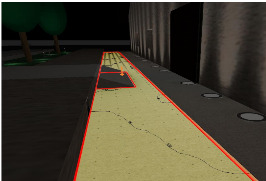
Εικόνα 6.61: Περιοχή αξιολόγησης διάδρομος επισκεπτών και ένταση φωτισμού στο λογισμικό DIALux eno [Ίδια Επεξεργασία].
