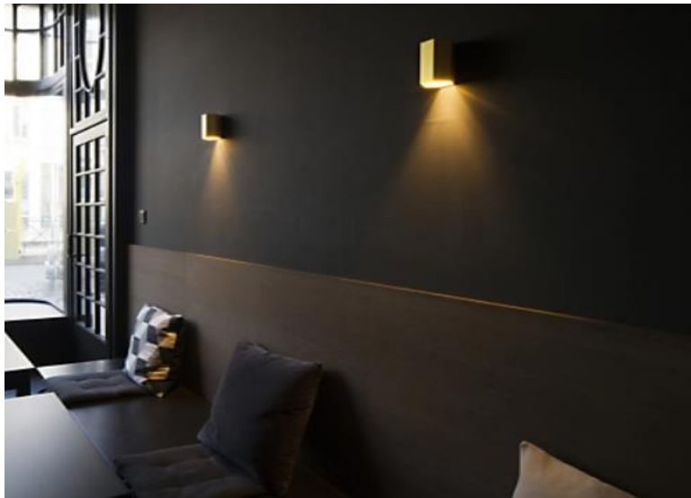
Εικόνα 2.11: Φωτισμός κάθετων επιφανειών με εστιακές απλίες[7].
