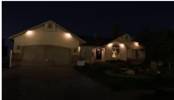
Εικόνα 2.13: Φωτισμός down lighting[7].
