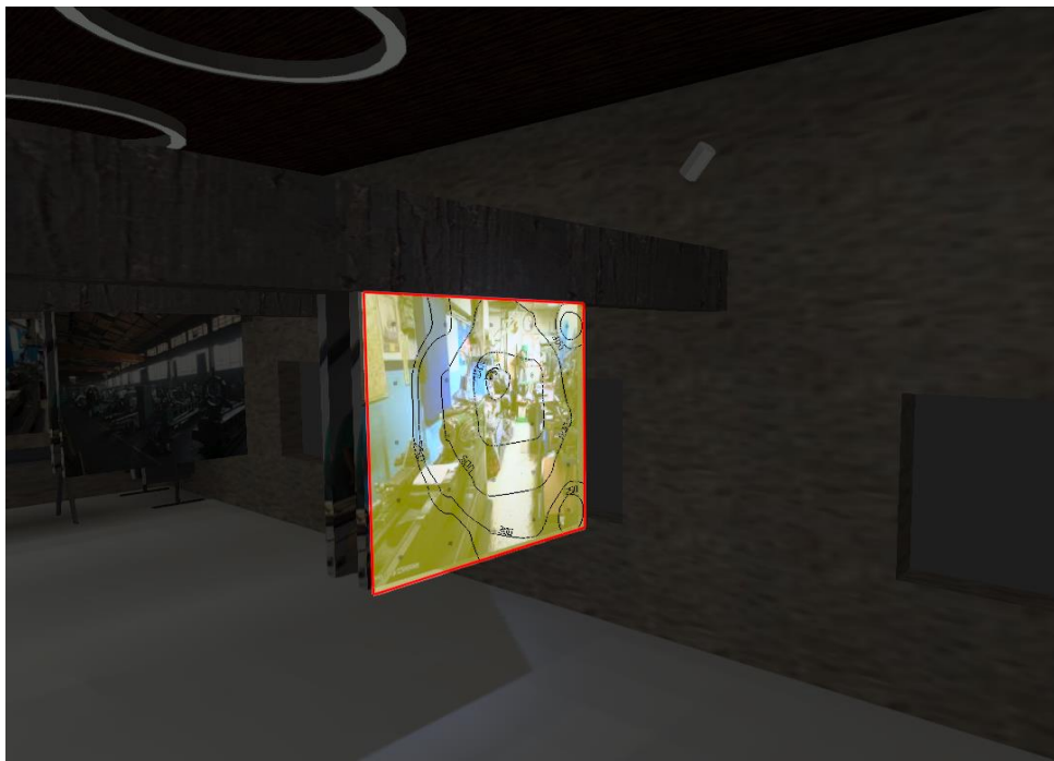
Εικόνα 6.58: Περιοχή αξιολόγησης πίνακα έκθεσης και ένταση φωτισμού στο λογισμικό DIALux ενο, «Κεντρική Σάλα» [Ιδία Επεξεργασία].
