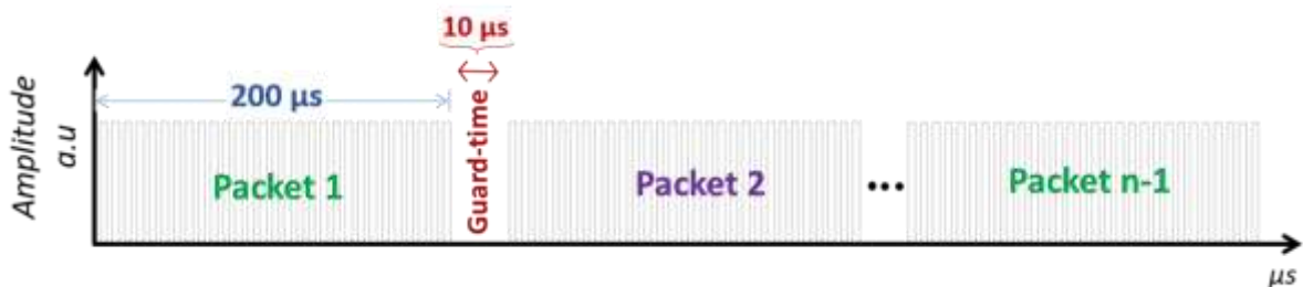
Εικόνα 29: Η δομή των πακέτων της αρχιτεκτονικής του προτεινόμενου υβριδικού δικτύου
