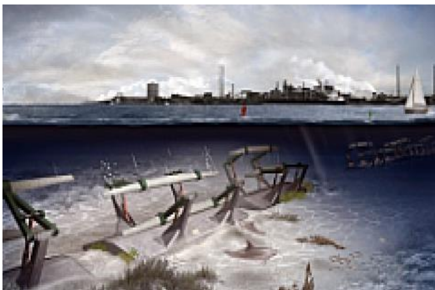
Εικόνα 7: Το Έργο Pulse Stream 1200 για την εκμετάλλευση της παλιρροϊκής ενέργειας με παλινδρομούντα πτερύγια [24].
