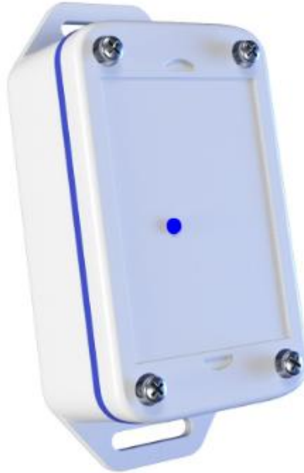
Σχήμα 5.9: Τελική συσκευή LoRaWAN - The Things Industries Generic Node Sensor Edition [51].
