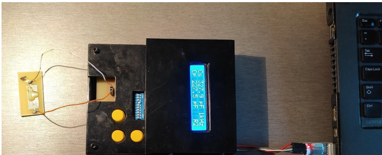
Σχήμα 5.33: Το πρωτότυπο κύκλωμα ανάγνωσης συνδέεται μέσω του PL2303 USB-TTL στη θύρα COM7 του υπολογιστή.
