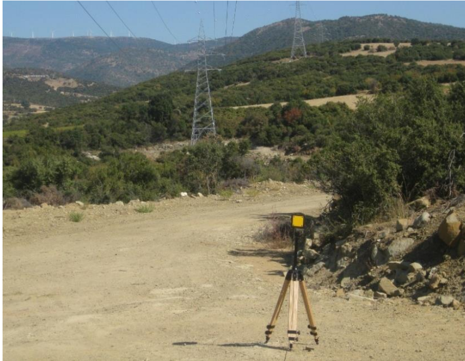
Φωτογραφία 6.3 : Μέτρηση ηλεκτρικού πεδίου στον κάθετο άξονα μεταξύ των πυλώνων
