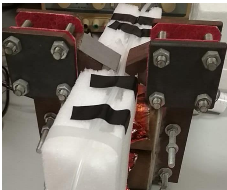
Σχήμα 3.3.7: Πειραματική διάταξη αποτελούμενη από τον ηλεκτρομαγνήτη και το σωλήνα από όπου διέρχονται τα μικροφύκη μέσω της περισταλτικής αντλίας
