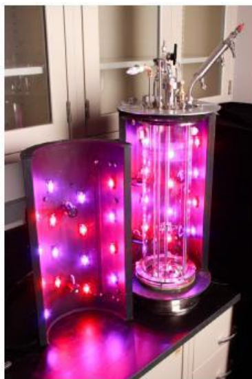
Σχήμα 2.3.5: Φωτοβιοαντιδραστήρας με ενσωματωμένες λυχνίες LED για την παραγωγή βιομάζας μικροφυκών. [11]
