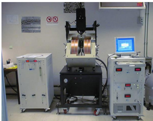
Σχήμα 3.5.5: Φωτογραφία ενός μαγνητομέτρου VSM. Διακρίνονται οι δύο ηλεκτρομαγνήτες μεταξύ των οποίων τοποθετείται το δείγμα καθώς και το σύστημα ταλάντωσης του δοκιμίου [167]
