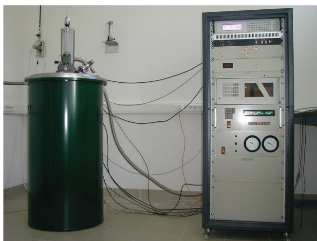
Σχήμα 3.5.6: Φωτογραφία ενός μαγνητομέτρου SQUID [168]
