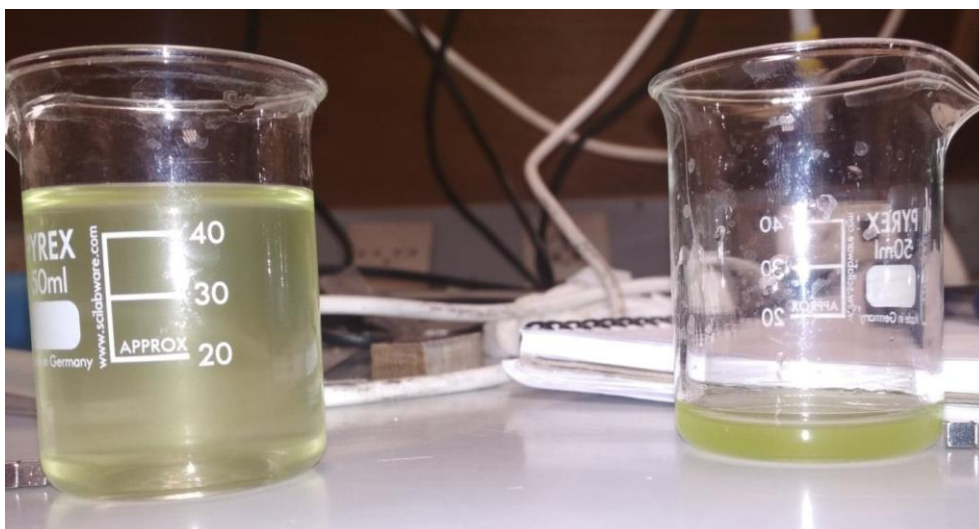
Σχήμα 3.3.11: Συμπύκνωμα, δεξιά, και παραπροϊόν, αριστερά, για δοκιμή με ηλεκτρομαγνήτη
