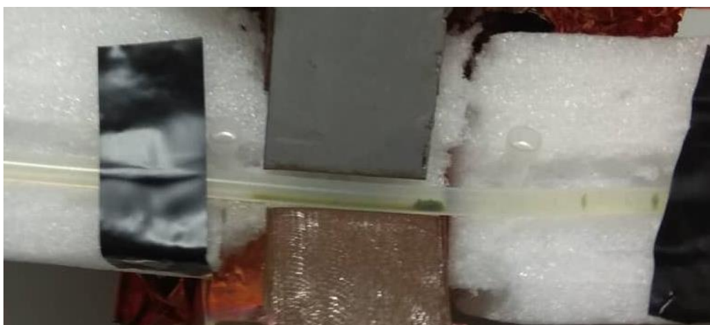
Σχήμα 3.3.15: Σημείο εναπόθεσης μικροφυκών, δοκιμή ηλεκτρομαγνήτη, Ένταση 5A, ροή 1ml/min
