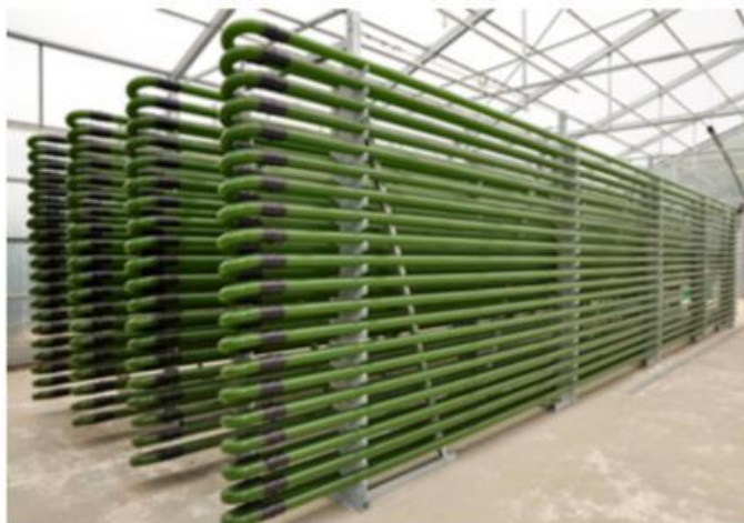
Σχήμα 2.2.3: Σωληνωτός βιονατιδραστήρας της Spiralps στη Γερμανία [11]
