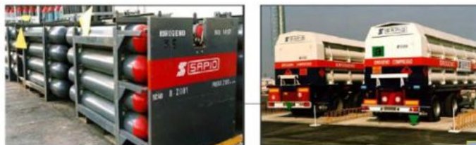
Εικόνα 25. Κύλινδροι αποθήκευσης HPGH 2 και φορητά δοχεία
