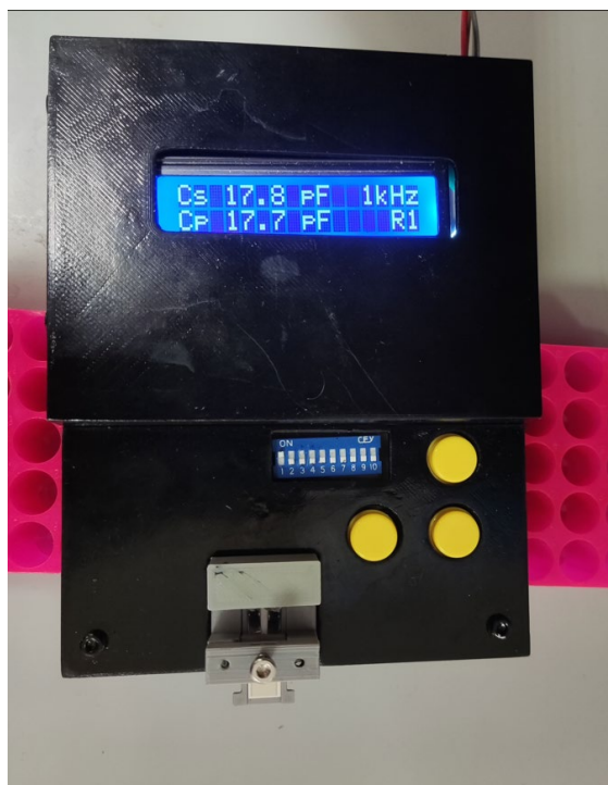
Σχήμα 24 Πρωτότυπο κύκλωμα ανάγνωσης
