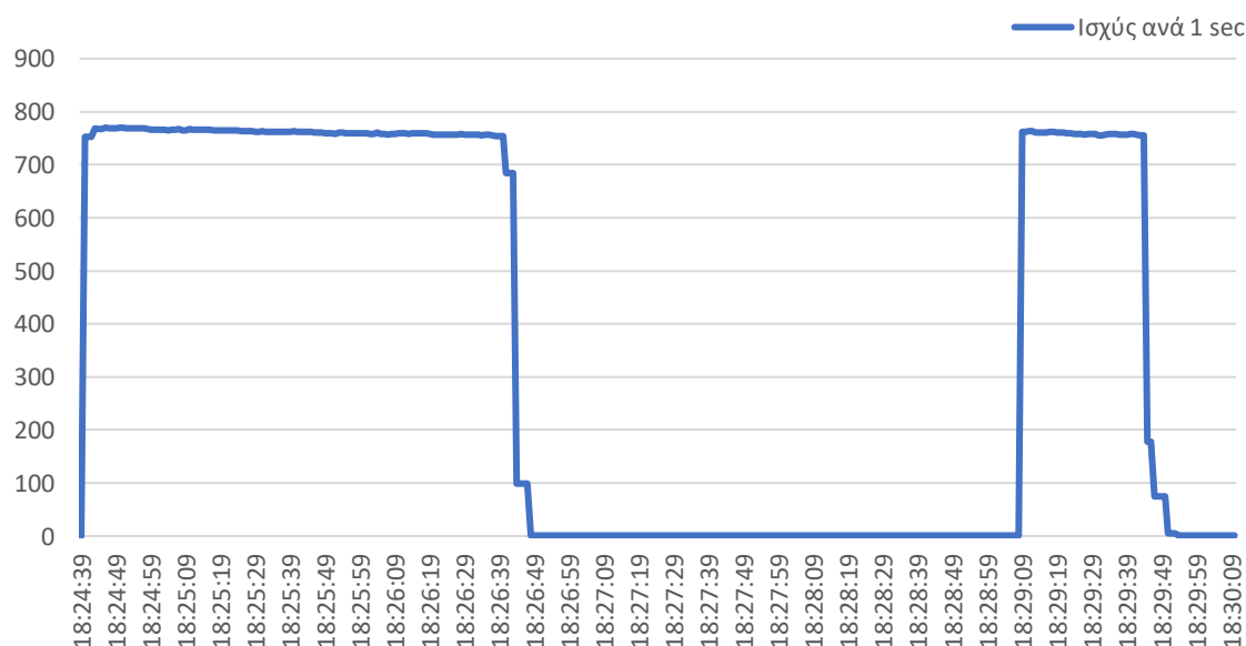
Σχήμα 4.15 Κυματομορφή Ενεργού Ισχύος Τοστιέρα 2
