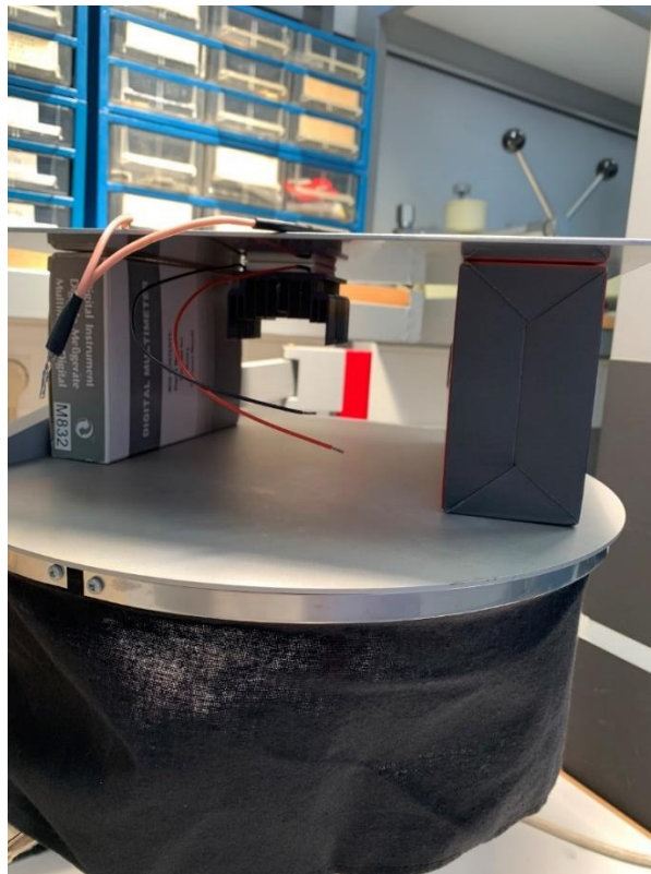
Σχήμα 5-17: Άποψη του θερμοηλεκτρικού και της ψύκτρας στην κάτω όψη του αλουμινίου
