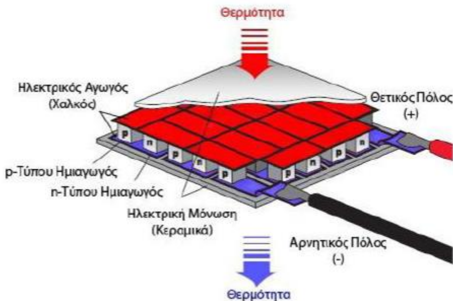
Σχήμα 3-7: Τομή θερμοηλεκτρικού στοιχείου Peltier [13].
