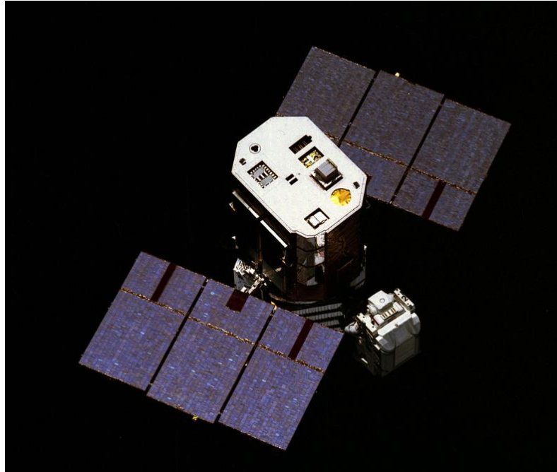
Σχήμα 2-22: Διαστημική εφαρμογή φωτοβολταϊκών GaAs εγκατεστημένων σε ηλιακό δορυφόρο [15].
