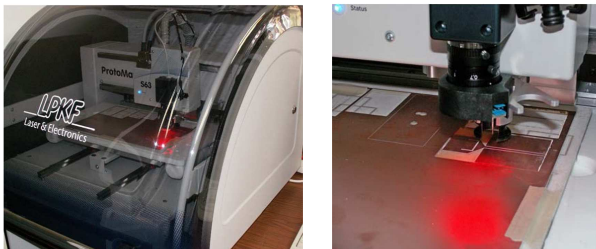
Σχήμα 4.4: Ειδικός εκτυπωτής τυπωμένων κυκλωμάτων (αριστερά) και η κεφαλή χάραξης (δεξιά) που χρησιμοποιήθηκε για την κατασκευή των τυπωμένων αναδιαρθρώσιμων μικροταινιακών κεραίων με ενσωματωμένο μαγνητο-διηλεκτρικό υλικό.
