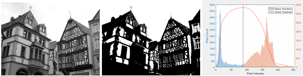
Σχήμα 3.14: Παράδειγμα thresholding χρησιμοποιώντας τον αλγόριθμο του Otsu [33].
