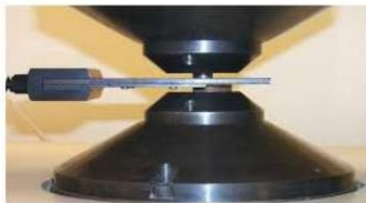
Εικ. 2.9: Δείγμα μαγνήτη ανάμεσα σε πολικά κομμάτια σε γράφο υστέρησης. Το δείγμα περιβάλλεται από επίπεδη σειρά σπειρών.
