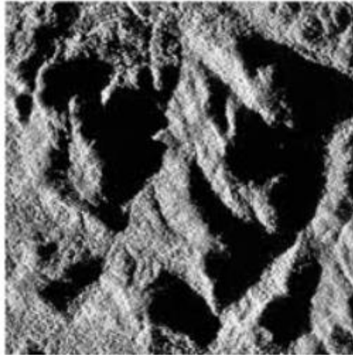
2.4.8: SAR Εικόνα με Παραμόρφωση Shadowing
