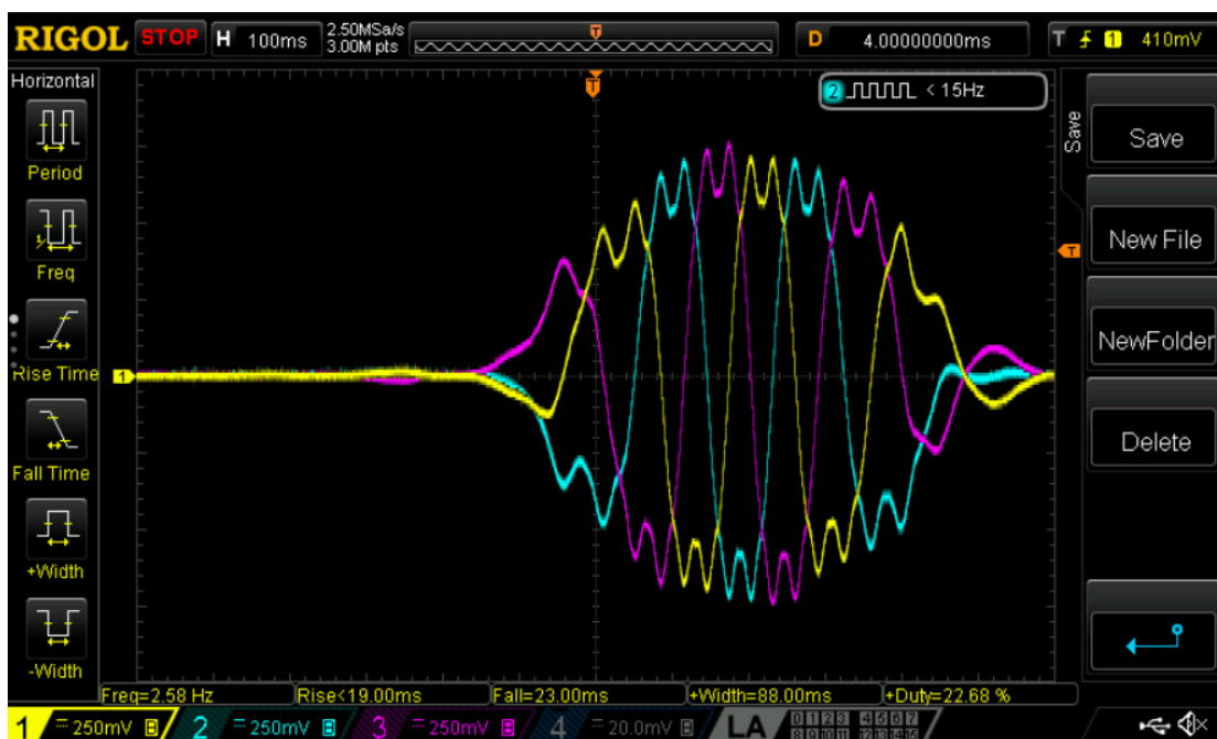
Εικόνα 5.4 Στιγμιότυπο παλμογράφου της ΗΕΔ από επαγωγή στα άκρα των τυλιγμάτων
