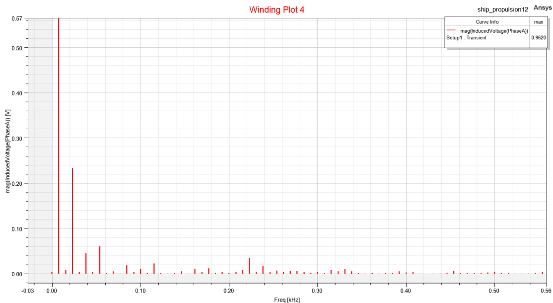
Εικόνα 5.10 Τα πλάτη των αρμονικών της ΗΕΔ της φάσης Α που μετρήθηκε στο εργαστήριο
