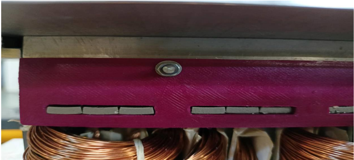
Εικόνα 5.2 Οι μαγνήτες μέσα στις θήκες.
