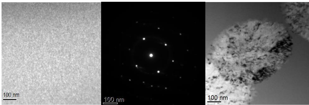
Σχήμα 2.41. Εικόνες TEM για το δείγμα \text{Fe}_{80}\text{B}_{20} , όπου φαίνεται η άμορφη κατάσταση στο δείγμα όπως παρήχθη (αριστερά), η κρυσταλλική απόκριση περίθλαση ηλεκτρονίων - SAED (κέντρο) και η νανοκρυστάλλωση (δεξιά).
