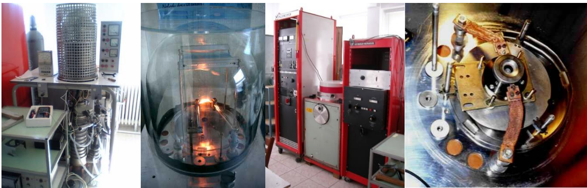
Σχήμα 2.24. Διάταξη φυσικής εναπόθεσης ατμών με θέρμανση του κράματος σε βάθρο τανταλίου (αριστερά και αριστερά – κέντρο). Διάταξη φυσικής εναπόθεσης ατμών με τη μέθοδο της δέσμης ηλεκτρονίων. Στον υποδοχέα που διακρίνεται, τοποθετείται το μητρικό κράμα.
