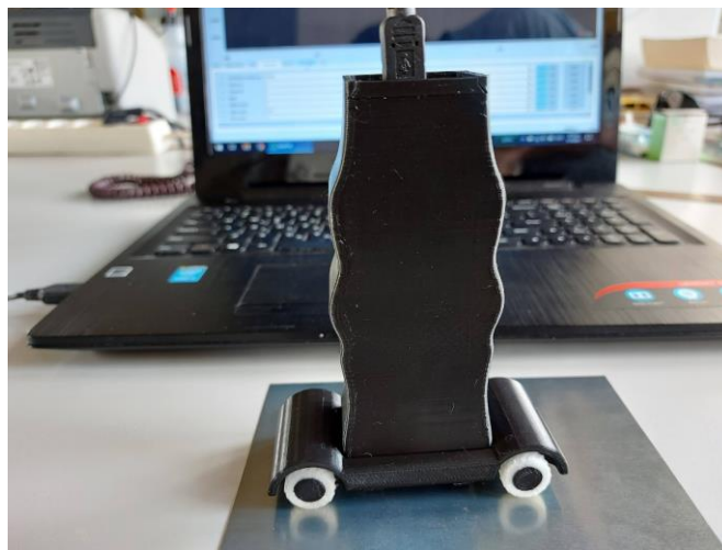
Σχήμα 83. Τελική μορφή του αισθητήρα μόνιμου μαγνήτη συνδεδεμένου με υπολογιστή μέσω USB [178].
