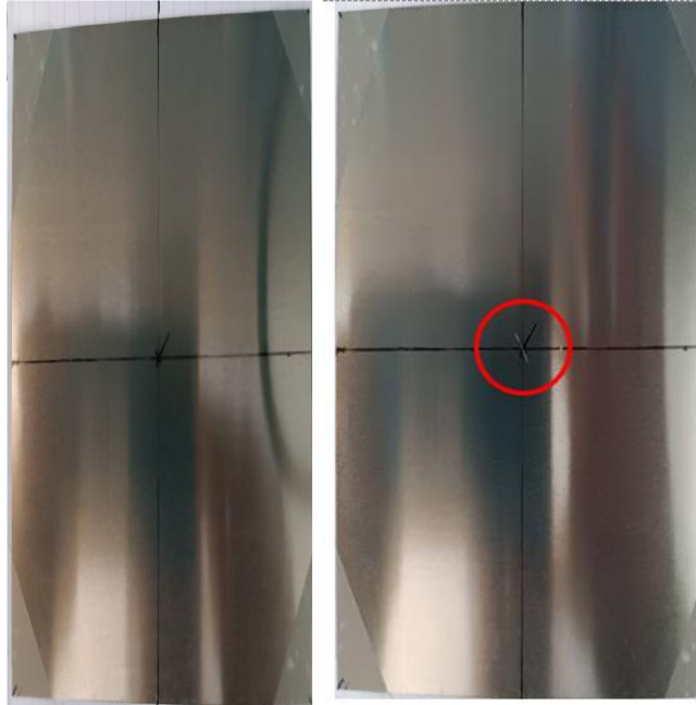
Σχήμα 84. Το δοκίμιο πριν (αριστερά) και μετά την προσθήκη της ατέλειας στο κέντρο (δεξιά) [183].
