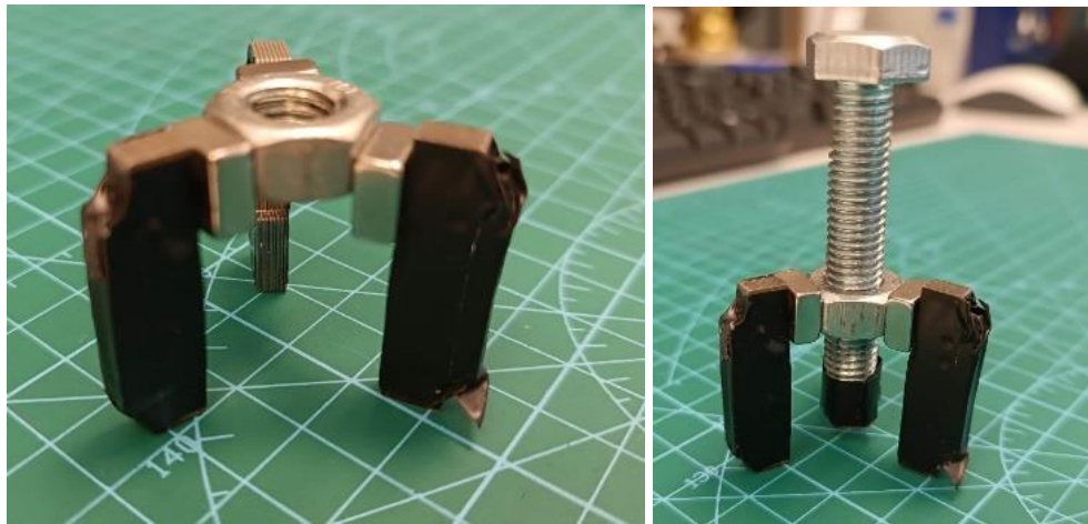
Σχήμα 98. Τρίποδο μαγνητικού κυκλώματος.
