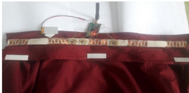
Εικόνα 28: Εισαγωγή του διαηλεκτρικού χωρητικού δικτύου αισθητήρων στο παλτό. [249]
