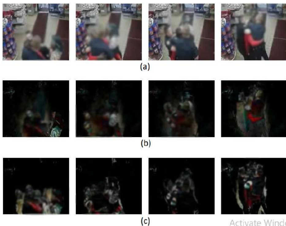
Σχήμα 3.14: Προεπεξεργασία εισόδου του μοντέλου. Το (α) δείχνει μη επεξεργασμένα καρέ του βίντεο, το (β) δείχνει το αποτέλεσμα της καταστολής του βίντεο του (α) και το (c) δείχνει τις διαφορές των καρέ του βίντεο του (α) (Islam 2021 [9])
