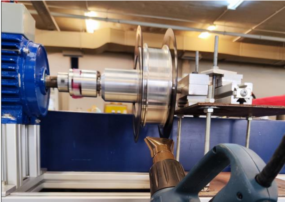
Σχήμα 4. 9. Αύξηση της θερμοκρασίας της γεννήτριας με την χρήση του heatgun Bosh GHG 660 LCD Professional.
