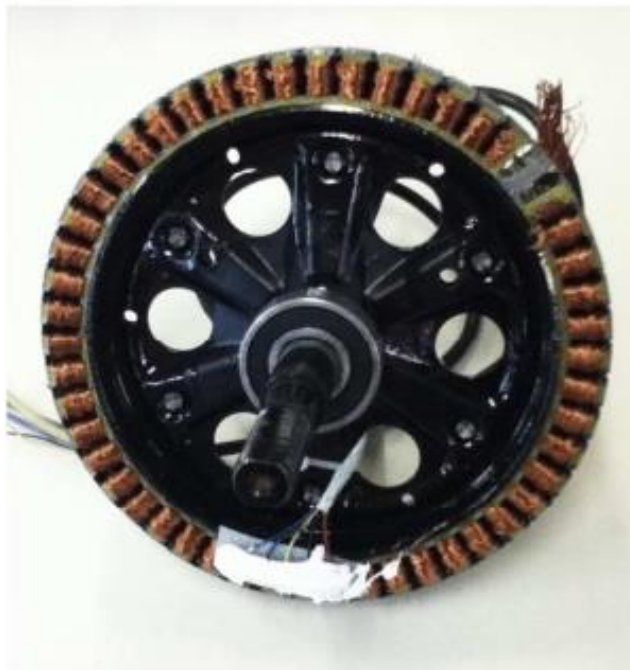
Σχήμα 4. 1. Εσωτερικό της μηχανής με τον στάτη απομονωμένο.
