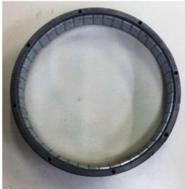
Σχήμα 4. 2. Εσωτερικό της μηχανής με τον δρομέα απομονωμένο.
