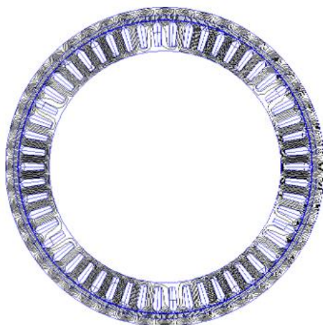
Σχήμα 8. 11. Η ροή του μαγνητικού πεδίου στον Κινητήρα 51.
