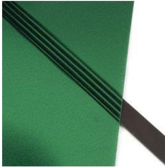
Εικόνα 10. Οι μαγνητικές γραμμές που χαρακτηρίζουν τη μαγνητική ταινία οι οποίες φέρουν διαφορετική πολικότητα διαδοχικά
