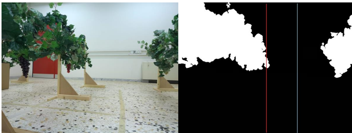
Σχήμα 4-18. Στιγμιότυπο της κάμερας του ρομπότ και η αντίστοιχη τμηματοποιημένη εικόνα όταν έχει ισαπέχουσες αποστάσεις από τα αμπέλια και περιστροφή γύρω από τον εαυτό του.
