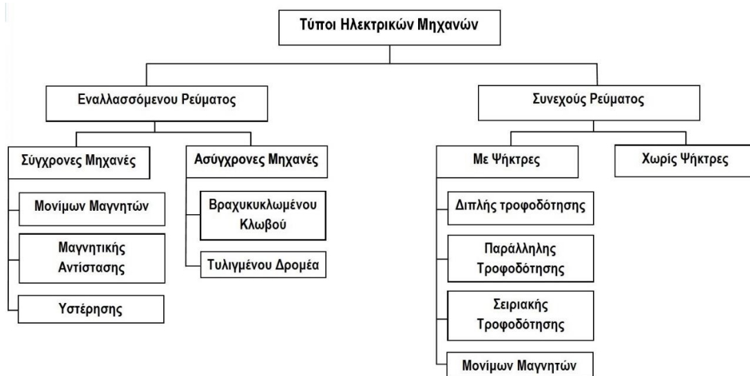
Σχήμα 2.5: Σχηματική αναπαράσταση των τύπων ηλεκτρικών κινητήρων ανάλογα με την σχεδίαση στάτη-δρομέα και την αρχή λειτουργίας τους
