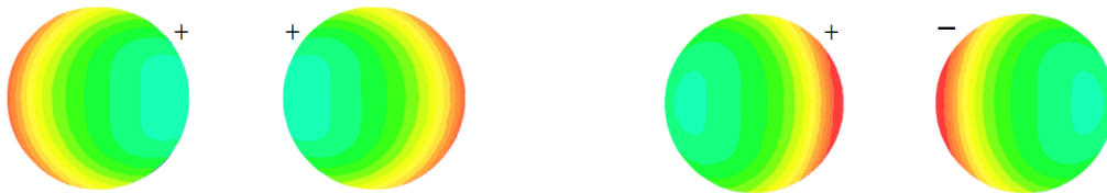
Σχήμα 2.30: Το φαινόμενο γειτνίασης σε 2 αγωγούς: (αριστερά) Όταν τα ρεύματα έχουν ίδια φορά, (δεξιά) όταν τα ρεύματα έχουν αντίθετη φορά
