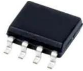
Εικόνα 20(Κ.4.2.1) Μετρητικά ρεύματος που επιλέχθηκαν [23].
