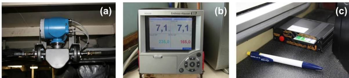
Εικόνα 6.1 Σύστημα απόδοσης καυσίμου κινητήρα τοποθετημένο επί των παρακολουθούμενων αλιευτικών σκαφών. (α) αισθητήρες ροής μάζας για τη μέτρηση της κατανάλωσης καυσίμου, (β) καταγραφέας πολλαπλών καναλιών τοποθετημένος στη γέφυρα του σκάφους για οπτικοποίηση της κατανάλωσης καυσίμου, (γ) καταγραφέας δεδομένων GPS.
