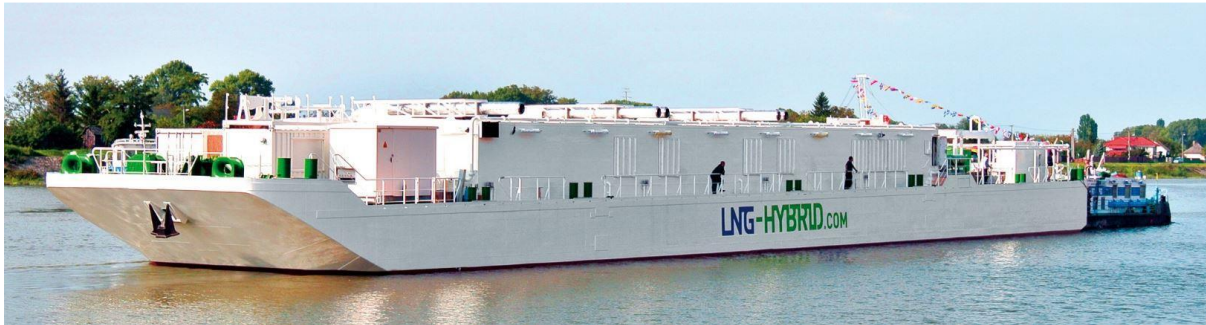
Εικόνα 6.21 Φορτηγίδα εναλλακτικής ισχύος με καύσιμο LNG
