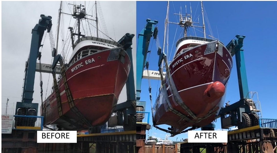
Εικόνα 6.5 Μετασκευή αλιευτικού σκάφους με βολβοειδή πλώρη
