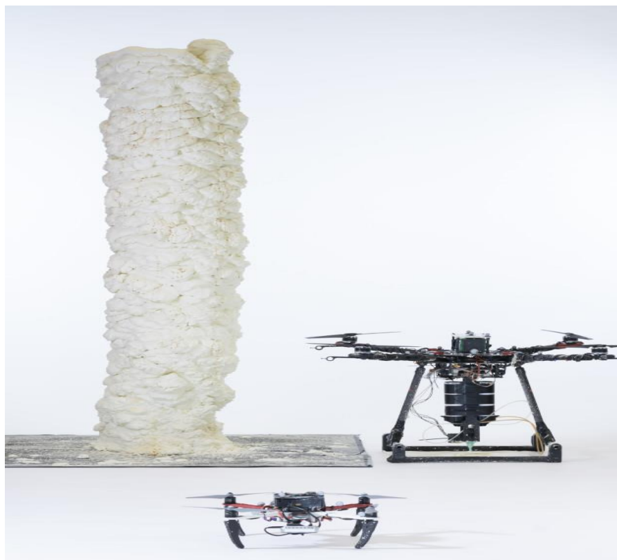
Εικόνα 21: Πύργος από αφρό, εκτυπωμένος από drone. 21
