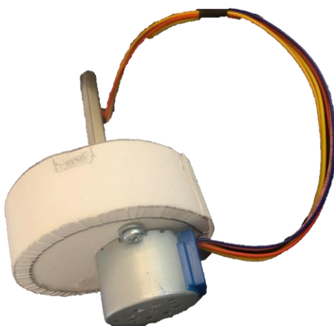
Εικόνα 15: Μηχανισμός περιστροφής τμημάτων φαρμακευτικών αγωγών
